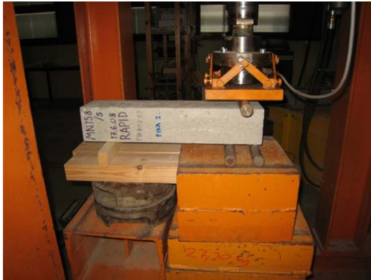
Kuva 17. Betonipalkin lohkaus 50 kN Kuormituskehällä
