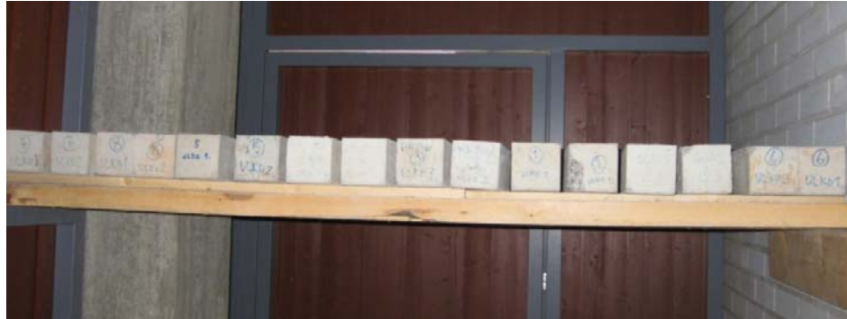
Kuva 14. Ulko-olosuhteessa olevat koekappaleet
