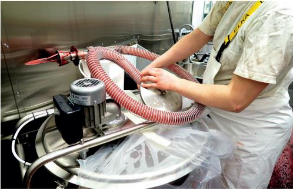
Veri otetaan talteen putkipistimellä maitotankkiin.
