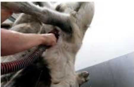
Putkipistintä käytettäessä veri valuu tankkiin letkua pitkin.
