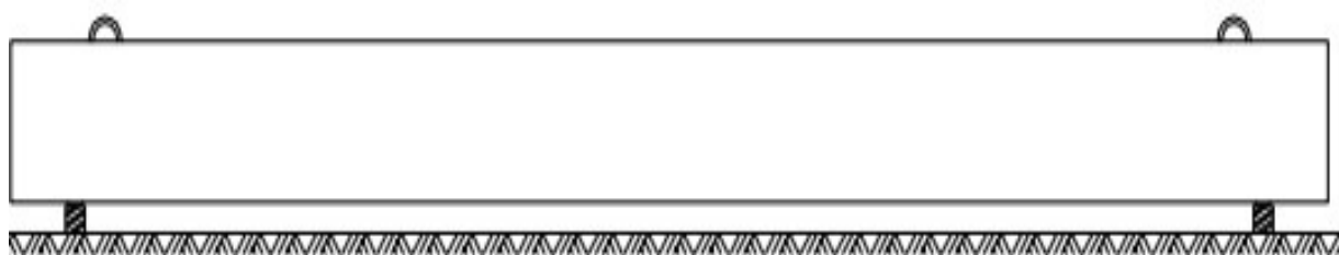
KUVA 12. Palkin varastointi työmaalla (Elementtisuunnittelu 2020.)
