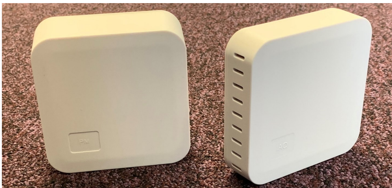
KUVA 1. Pienhiukkas- ja TVOC-anturit
