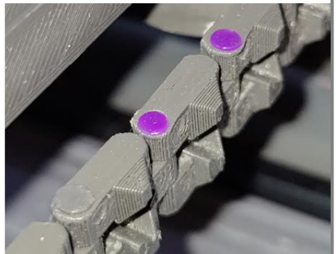
Kuva 16. telaketjujen liitos tulostuslangalla
