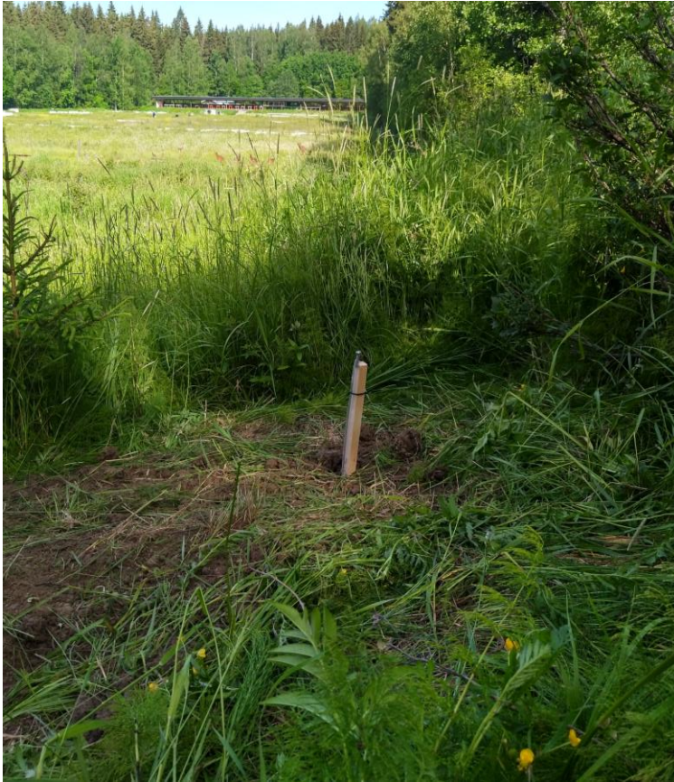
Kuva 11. Maahan upotettu ja asennettu lysimetri L2 siluettiradalla.
