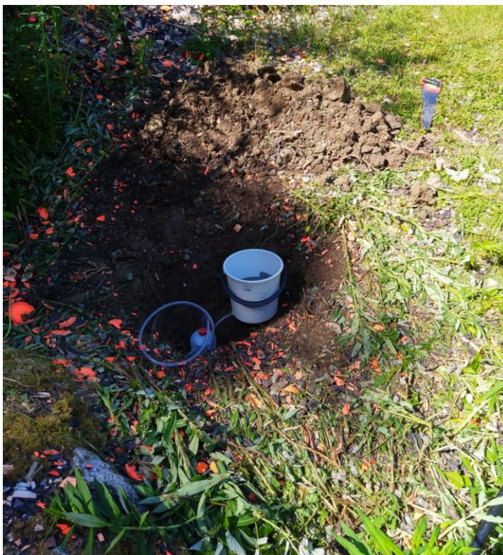
Kuva 9. Lysimetrin L3 asennusta.
