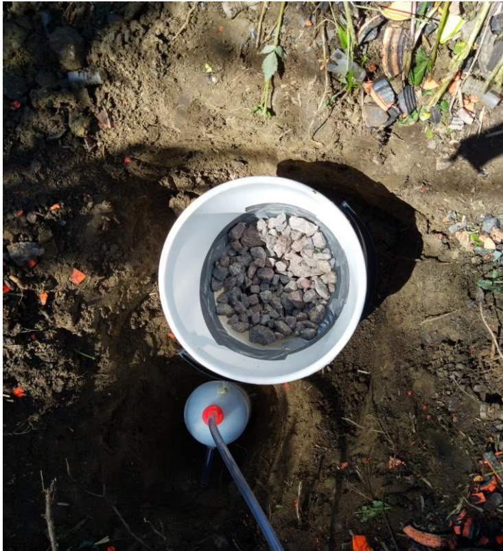
Kuva 10. Lysimetreihin laitettiin sorapatja tukkeumien estämiseksi.
