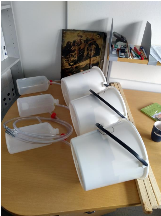
Kuva 8. Protomallit rakennetuista vajolysimetreistä.
