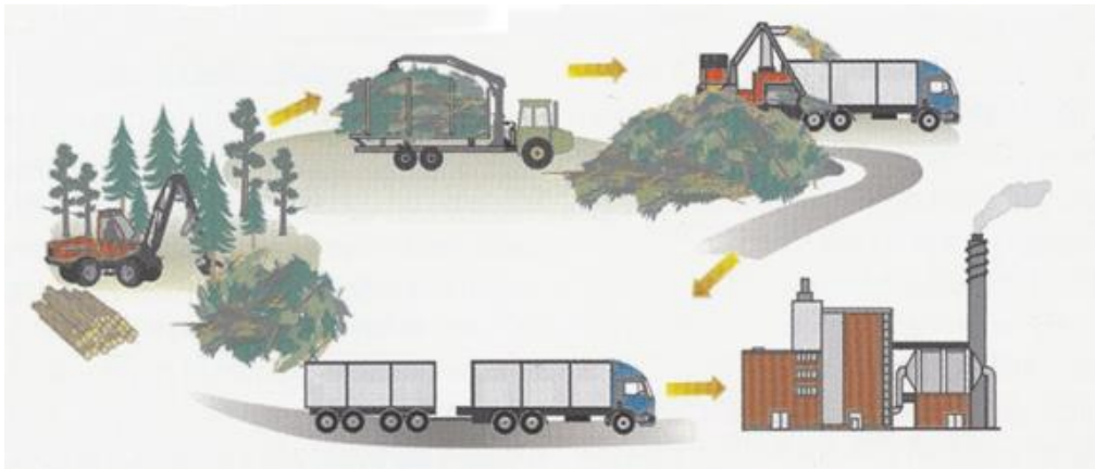
Kuva 2. Välivarastohaketusjärjestelmä (VTT Prosessit, Jyväskylän Teknologiakeskus Oy & BENET Bioenergiaverkosto 2003, 61 mukaan.)
