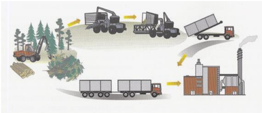
Kuva 1. Palstahaketusjärjestelmä (VTT Prosessit, Jyväskylän Teknologiakeskus Oy & BENET Bioenergiaverkosto 2003, 61 mukaan.)
