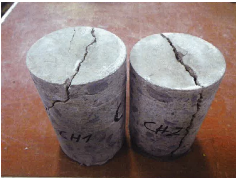
Kuva 15. Kuvassa kuitujen ansiosta yhdessä pysyvät lieriönäytteen puolikkaat (YIT Suomi Oy, 2020).
