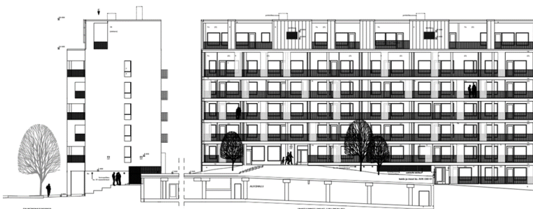
Kuva 2. Kuvassa julkisivukuva kahdesta kerrostalosta, jonka alle on rakennettu puoliksi maanalainen pysäköintihalli (SokoPro).
