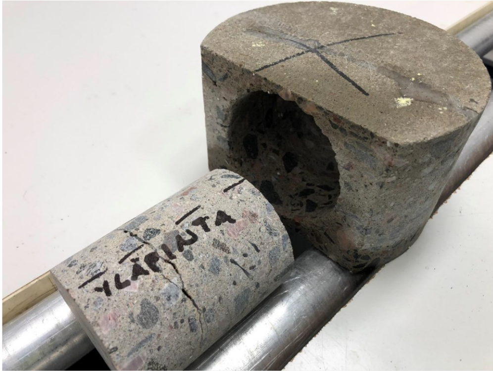
Kuva 17. Lattiasta poratusta näytteestä porattiin sivuttaissuunnassa pienempi lieriö injektioinnin tartuntavetolujuuden testausta varten (YIT Suomi Oy, 2020).
