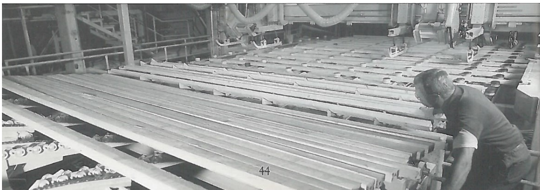
Kuva 4. Kuivalajittelulaitos. Ajomies lajittelemassa sahatavaradimensiota (Yhtä näyttöpaikkaa, Similä 1997)
