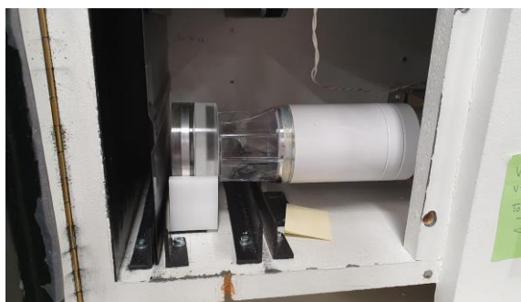
Kuva 16. Pitkä kartiosuodatin kiinnitettynä putkipäähän, kontrastityökalu telineellä, sekä kuvalevyn suoja asetettuna kuvalevyntukeen.
