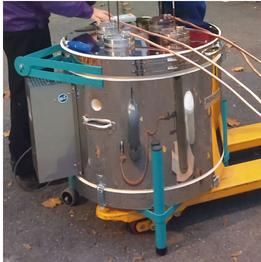
Kuva 4. HAMK:n pyrolyysikoe-laite. (Kuva: Annakaisa Elo, HAMK)
