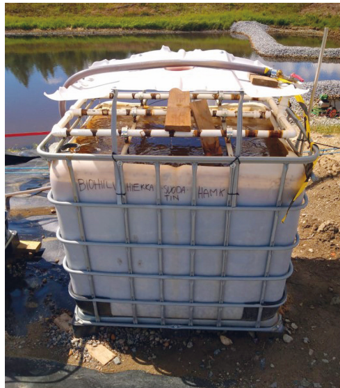
Kuva 26. Suotoveden käsittelykontit, kaaviokuvana ja kuva toteutuksesta. (Kuva: Jarkko Nummela, HAMK)
