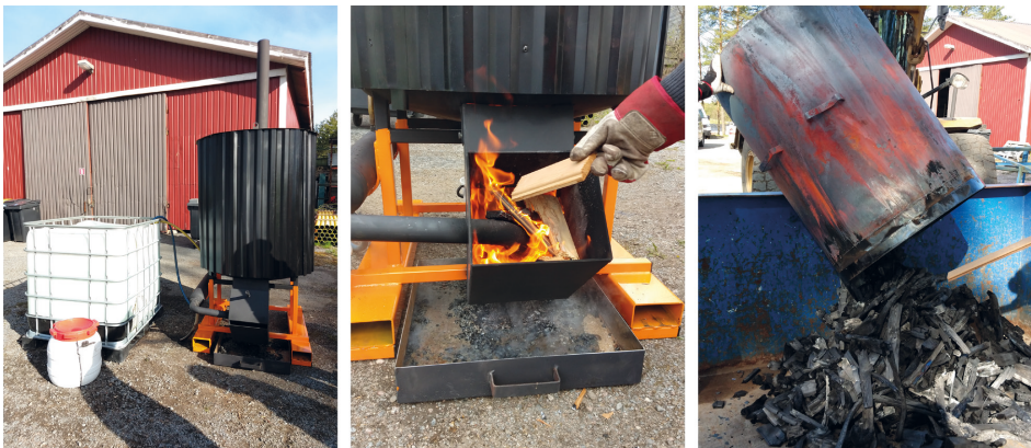
Kuva 12. Purkupuun biohiillettystä Mayt Oy:n pyrolyysiretortilla Kiertokapula Oy:n Karanojan alueella Hämeenlinnassa. (Kuvat: Annakaisa Elo)
