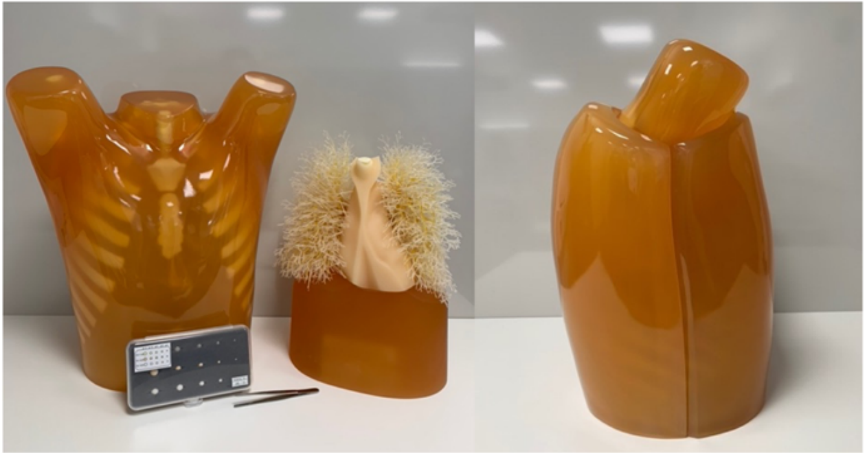
Kuva 1. Lungman Thorax-fantom, nodukset ja lisälevyt
