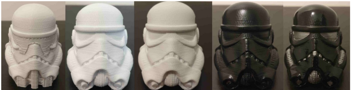
Kuva 10. Mallin jälkiprosessointi. Kuvassa näkyy mallin näkymä eri prosessivaiheissa.
