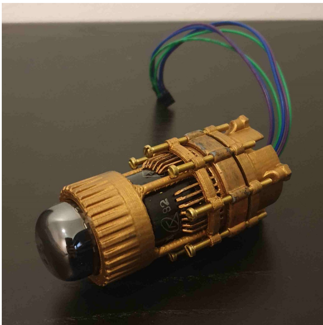
Kuva 11. Maalatut tulostetut mallit. Mallit on ruuvattu kiinni toisiinsa, ja ne suojaavat dekatron-komponentin.
