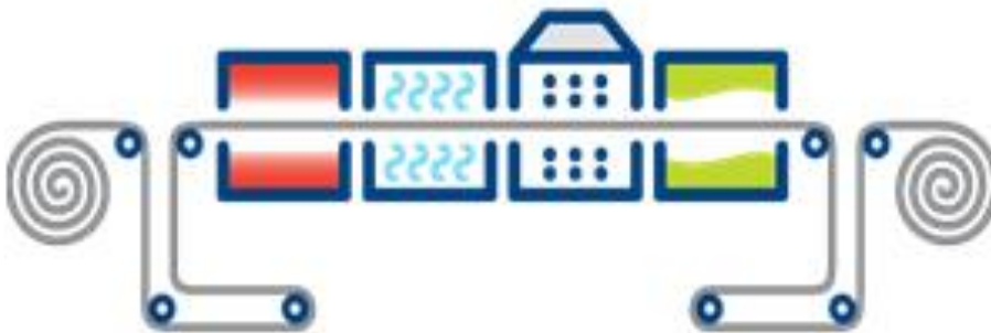
KUVA 1. Hehkutus-peittaus 3, yksinkertaistettu prosessikaavio (Outokumpu 2021c)
