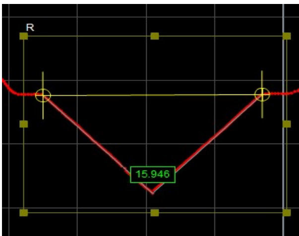
Kuva 7. Havainnekuva Profile Groove -työkalun toiminnasta (LMI Technologies 2015).
