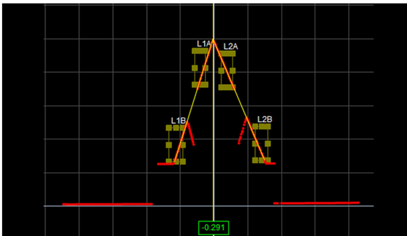
Kuva 8. Havainnekuva Profile Intersect -työkalun toiminnasta (LMI Technologies 2015).
