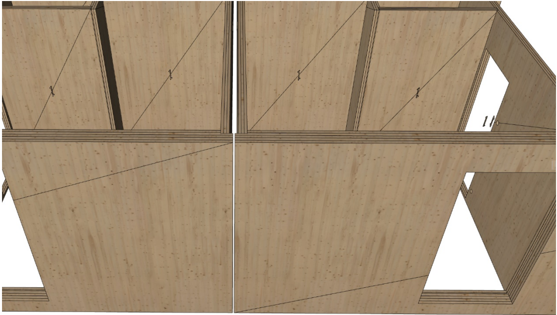
Kuva 11. Elementtien väliin jätettävä rako
