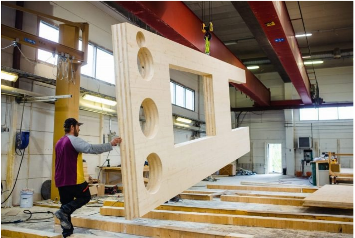
Kuva 5. CNC-työstökoneella onnistuu erimuotoiset työstöt (Hoisko 2020)
