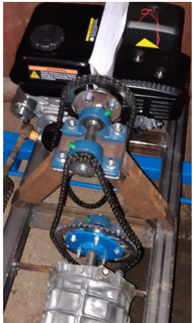
Voimansiirtojärjestelmä, jossa näkyy ensiövälityksen ketjuveto
