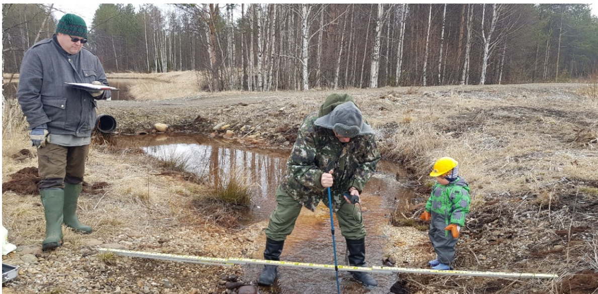
Kuva 37. Tarmo Tossavainen mittaa Flowatch™ -siivikolla Linnunsuon kosteikon lähtevän uoman virtausnopeuksia virtaaman määritystä varten 29.04.2020. Tulosten kirjaajana toimii tutkijatoh- tori Tero Mustonen Kontiolahdesta ja tilannetta tarkkailee Veeti Raassina. Foto: Janne Raassina.
