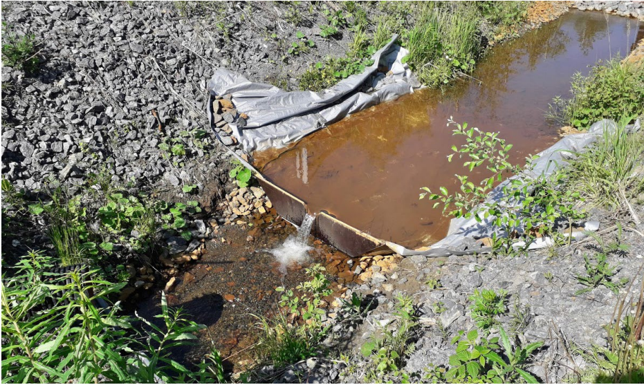
KUVA 1. Pitkäjärven käsittelyjärjestelmän ympäristössä käytettyjä V-aukollisia virtaamapatoja. Kuvassa yläjuoksun mittapato (kuva Aki Mykkänen).
