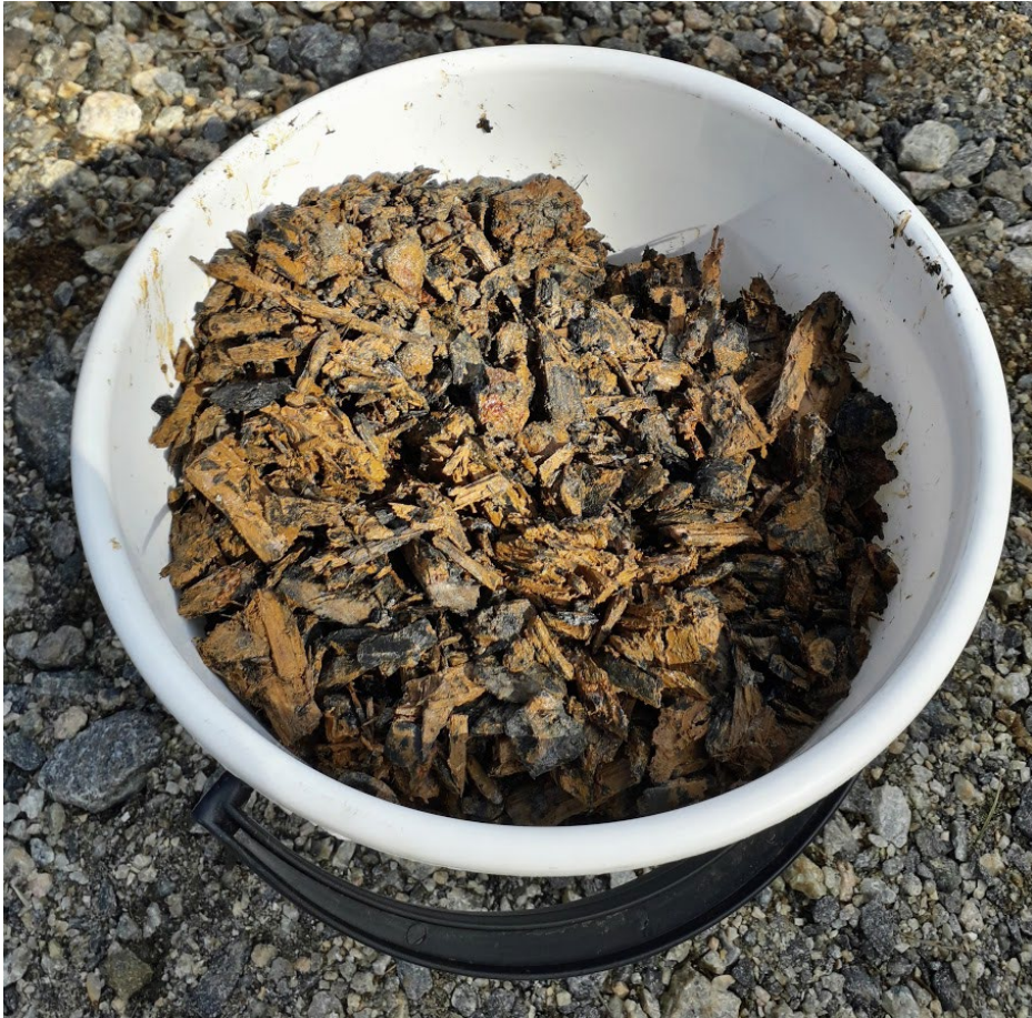
KUVA 6. Vuoden 2019 noin kolmen kuukauden käytön jälkeiset suodatinmateriaalit, jotka ovat selkeästi suotovedestä saostuvan rautasakan peittämiä (kuva Aki Mykkänen).
