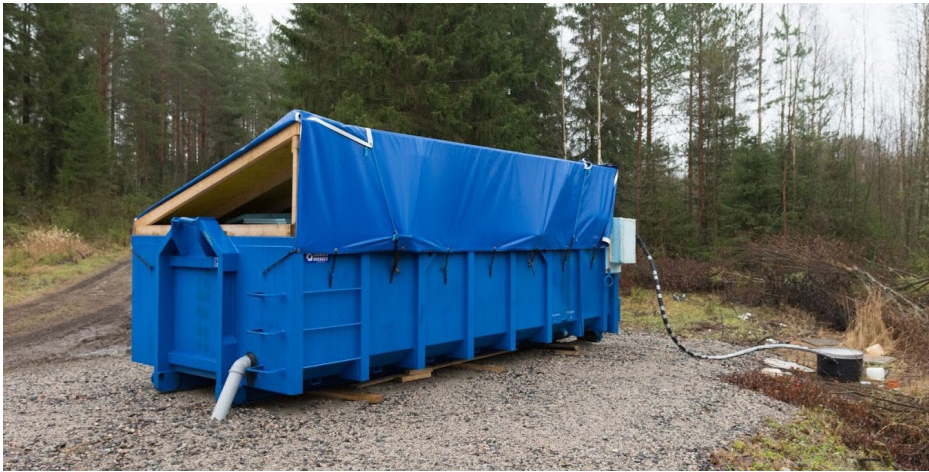
KUVA 2. Biosuodatuslaitteisto syksyllä 2019. Kuvassa oikealla nähtävissä tulokaivo, josta suotovesi johdetaan letkulla lavalle. Laitteiston harmaa poistoputki vasemmalla (kuva Aki Mykkänen).
