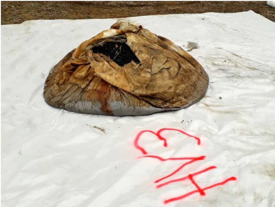
KUVA 6. HV3-kaivosta poistettu suodatinmateriaalit sisältävä silttikankainen pussi muutostöiden aikaan. Pussi on likaantunut sekä tukkeutunut vuoden 2019 aikana niin, että vesi ei enää virtaa kankaan läpi (kuva Aki Mykkänen).
