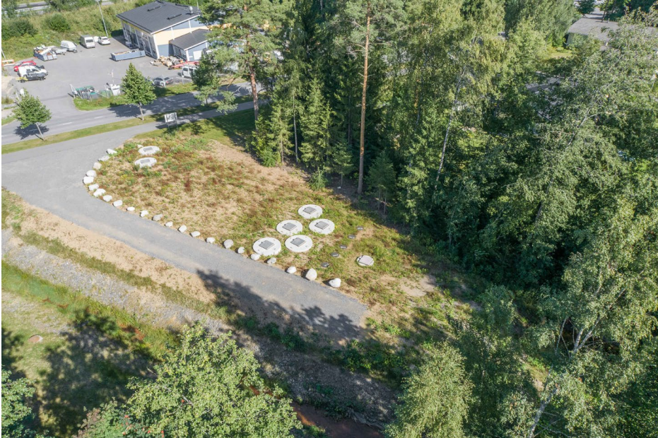
KUVA 2. Pitkäjärven hulevesijärjestelmän ilmakuva. Keskellä näkyvät viisi vierekkäistä kaivoa sisältävät suodatinmateriaalit (kuva Juha Vihavainen).
