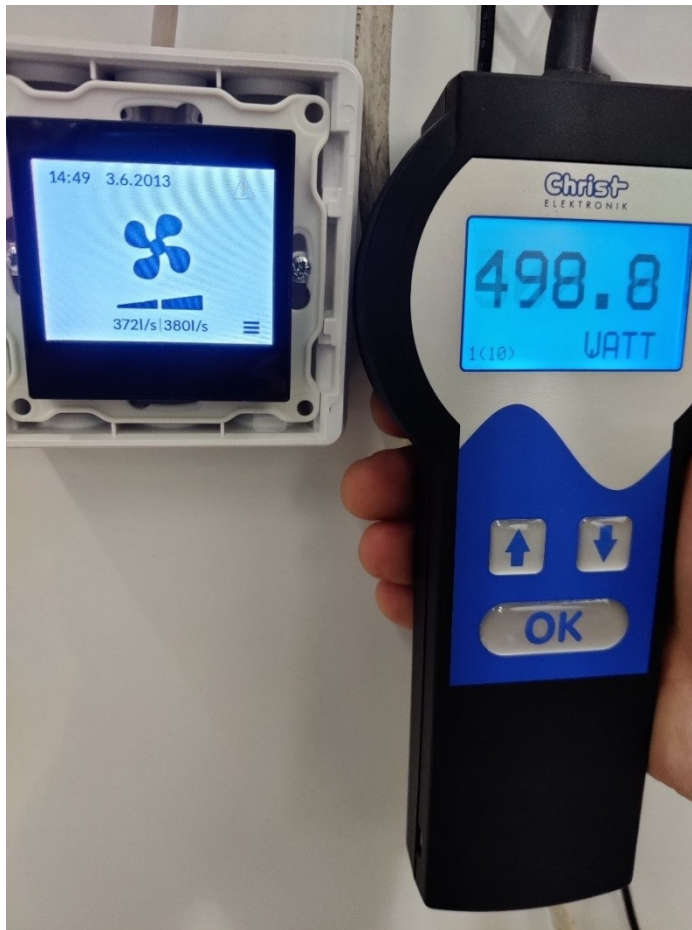
Kuva 18. Pureo-koneen tehonkulutus ohjaimesta näkyvillä ilmavirroilla.
