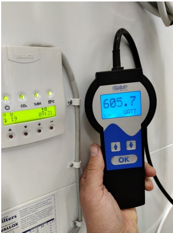
Kuva 17. Ilmava 252D:n tehonmittaus Christ Elektronik -pistotulppamittarilla, käyttöasennolla 8/8.
