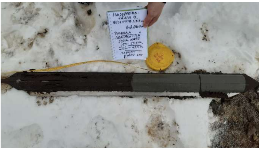
Kuva 25. Iso Somerojärvi 4, pohjasedimenttinäyte 155-255 cm 16.03.2021.
