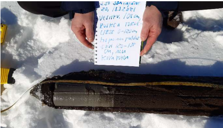
Kuva 46. Iso Somerojärvi 20, lähikuva sedimenttinäytteestä 18.03.2021, vesisyvyys 1,08 metriä.
