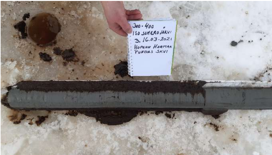
Kuva 24. Iso Somerojärvi 3, pohjasedimenttinäyte 300-400 cm, 16.03.2021.
