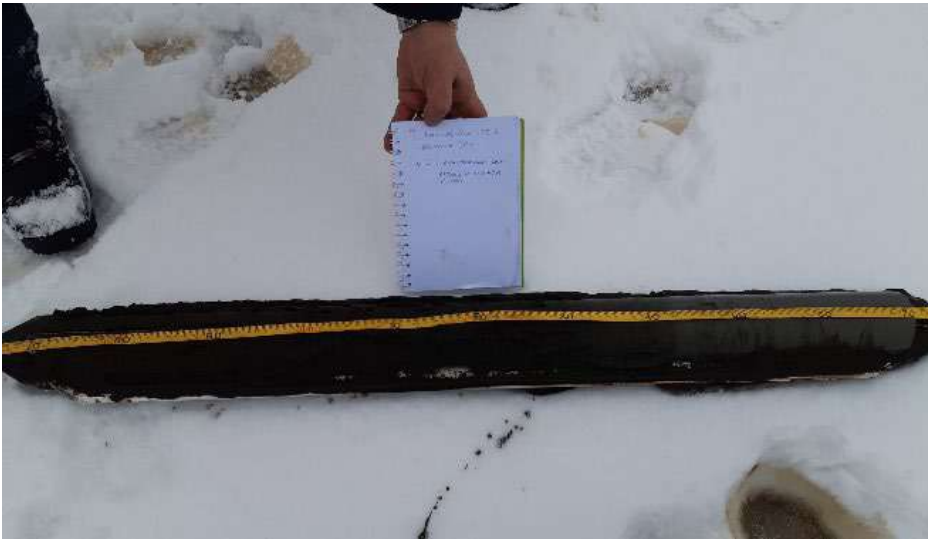
Kuva 32. Iso Somerojärvi 9, vesisyvyys 1,50 metriä, sedimenttinäyte 200–300 cm 17.03.2021.
