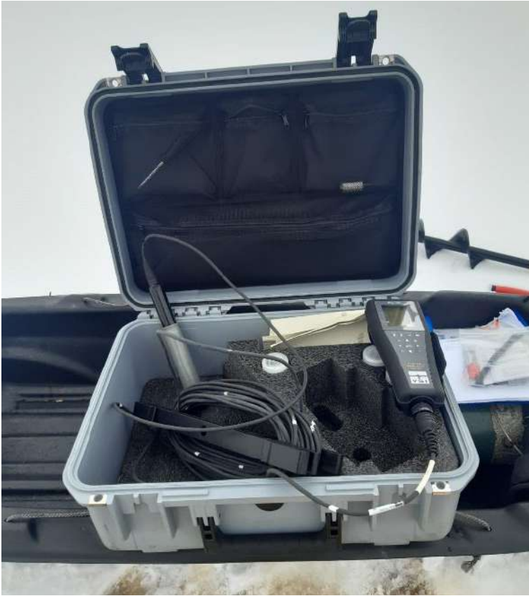
Kuva 14. Yksi ODO –kenttämittari veden liuenneen happipitoisuuden mittaukseen Ison Somerojärven pohjoispäässä 16.03.2021.
