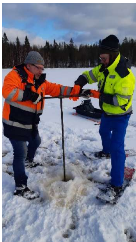
Kuva 9. Jari Laaksonen (vas.) ja Jani Tekokoski ottavat laippakairalla Ison Somerojärven pohja-sedimenttinäytettä 17.03.2021.
