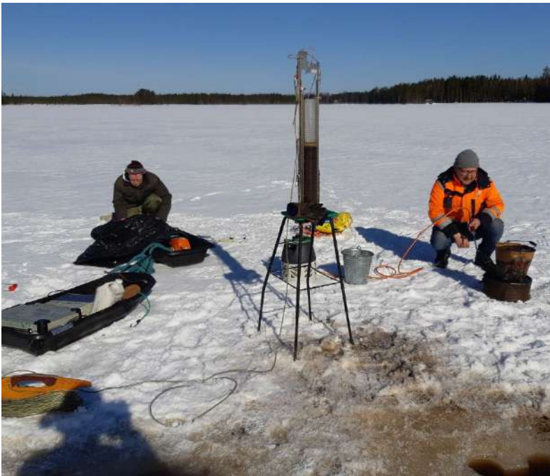
Kuva 13. Timo Louna (vas.) ja Jari Laaksonen keskisellä Isolla Somerojärvellä 19.03.2021. Keskellä viipaloivalla Limnos-sedimenttinoutimella otettu näyte redox-potentiaalin mittausta varten.
