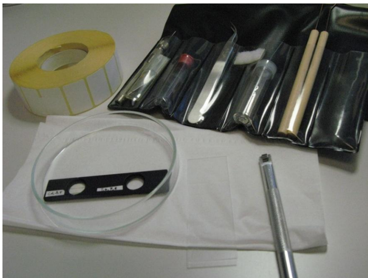
Kuva 7. Näytteenkäsittelyvälineistö: metallirulla, toiselta puolelta karhea objektilasi, KBr-tablettipidike, teippi sekä muut apuvälineet.
