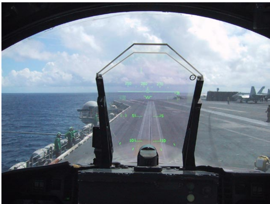
Kuva 5. Heijastusnäyttö F/A-18 hävittäjässä (Wikipedia 2020)
