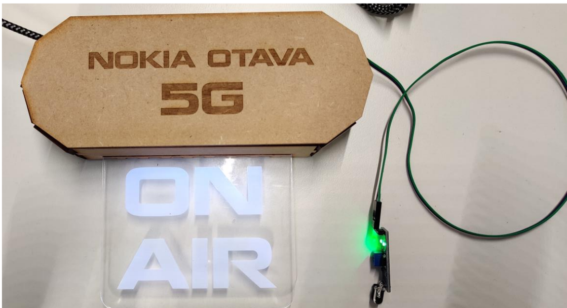
KUVA 5. Infobox ja infrapunasensori kytkettynä virtalähteeseen
