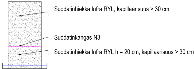
KUVA 12. Koe hiekalla suodatinkangas välissä. (Testisuunnitelma.pdf 2020.)
