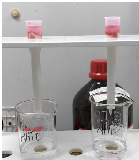
Kuva 5. Punaisen sakan muodostus kolonniin nikkelin reagoiessa dimetyylyglyoksiimin kanssa.
