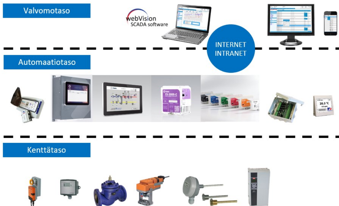
Kuva 18. Rakennusautomaatiojärjestelmän tasot (Fidelix Oy)
