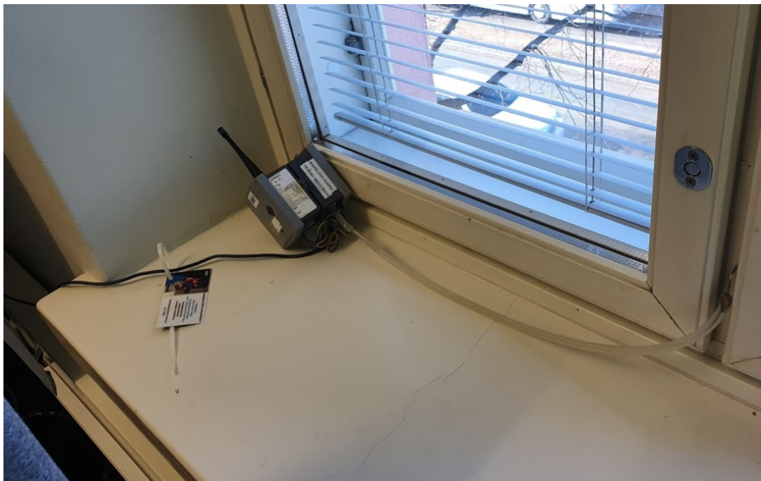
Kuva 31. ARE Oy:n wAreless paine-erolähetin
