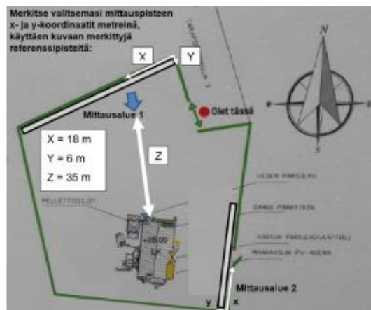
Kuva 4. Mittauspisteen (mikrofonin paikka) valinta, sekä X-, Y- ja Z-koordinaattien merkintä metreinä karttaan. KymiLabs:n valinta sinisellä nuolella. Heikkinen 2021.
