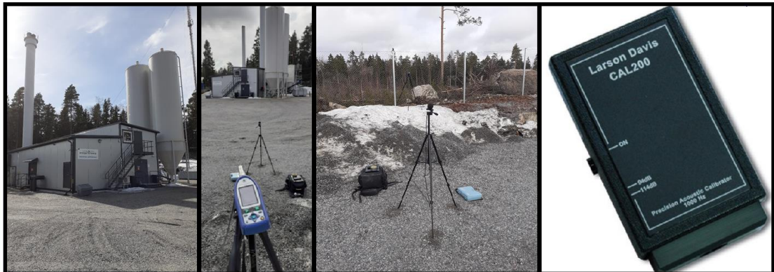
Kuva 6. Otoksia Tarapotin lämpökeskuksen melumittaus tapahtumasta. Kuvassa vasemmalta oikealle Tarapotin lämpökeskus, mittauspiste kohti melulähdettä laitteistoineen, mittauspisteen tausta ja viimeisenä oikealla äänitasomittarin akustinen kalibrointilaite. (Heikkinen 2021).
