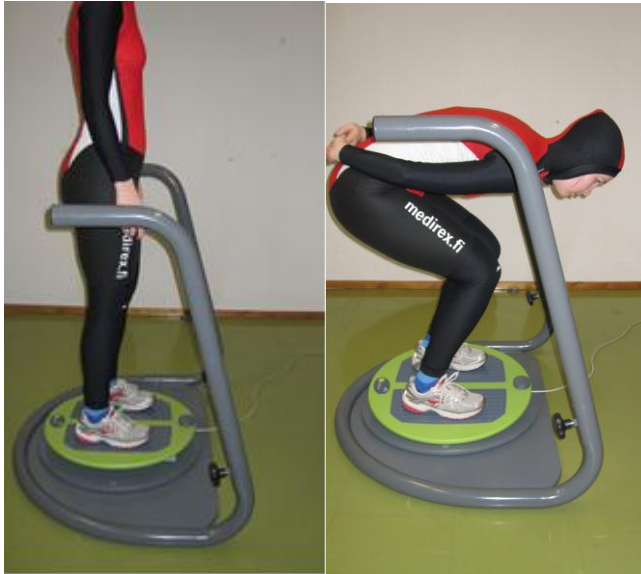
Kuva 4. Tasapainon stabiiliteetin mittaus seisoma- ja luisteluasennossa sivusuunnassa.
