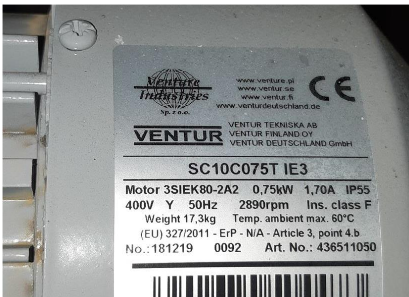
KUVA 14. Pakokaasuventtiilien ylipainepuhaltimen kilpiarvot
