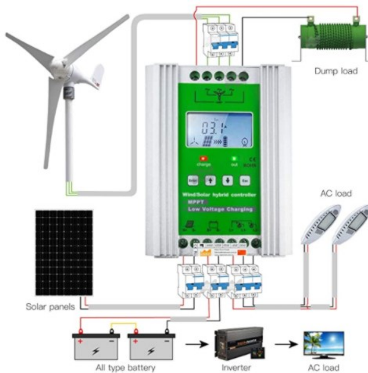
Figur 18. Kontrollsystemet kopplas till dessa komponenter. (amazon, u.d.a).
