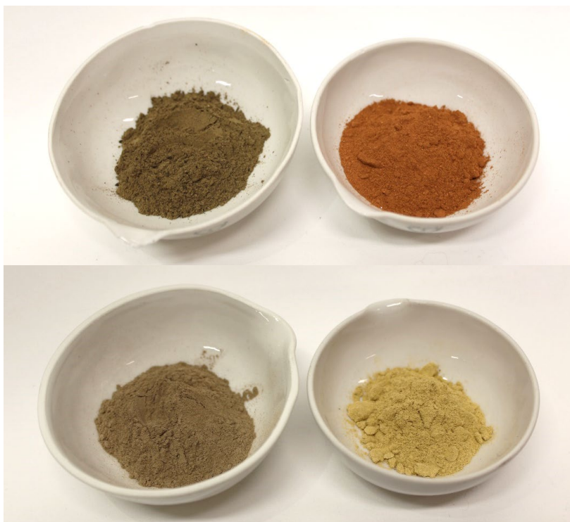
KUVA 2. Tuhkanäytteiden värimuutokset hehkutushäviön määrittämisessä. Lämpölaitoksen lentotuhka (yllä) ja jätteenpolttolaitoksen lentotuhka (alla). (Kuvat Tiina Saario)
