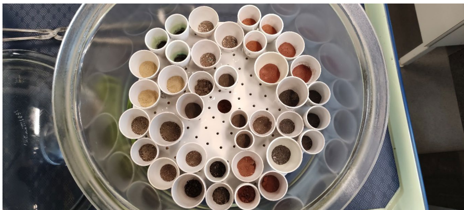
KUVA 1. Tuhkanäytteet hehkutushäviömäärityksen jälkeen. (kuva Tiina Saario)
