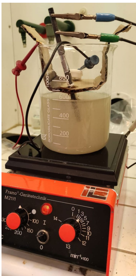
KUVA 7. Elektrolyysikenna magneettisekoittajalla. Vastaelektrodina platinalanka, työelektrodina hiilisauva ja referenssielektrodina Ag/AgCl-elektrodi. (kuva Tiina Saario)
