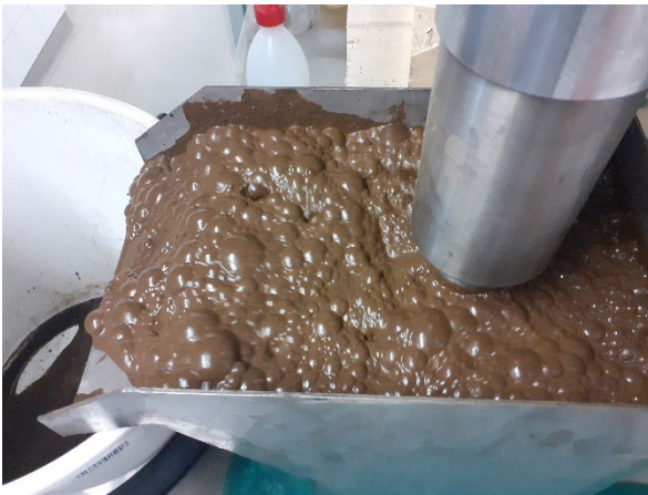
KUVA 2. Vaahdotuksen alkuvaihe, jossa kuplat ovat tasakokoisia ja vaahto on väriltään tummaa (kuva Teija Härkönen).
