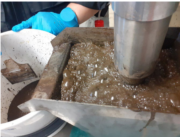
KUVA 3. Vaahdotuksen loppuvaihe, jossa kuplien koko on epätasainen, vaahdon väri vaaleampi ja vaahto epästabili. (kuva Teija Härkönen)
