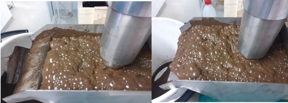
KUVA 3. Dieselmokkeissa ylitteeksi muodostuva vaahto. Vaahdotusaineena mäntyöljy 1 (vas.) ja 2 (oik.) (kuva Teija Härkönen)
