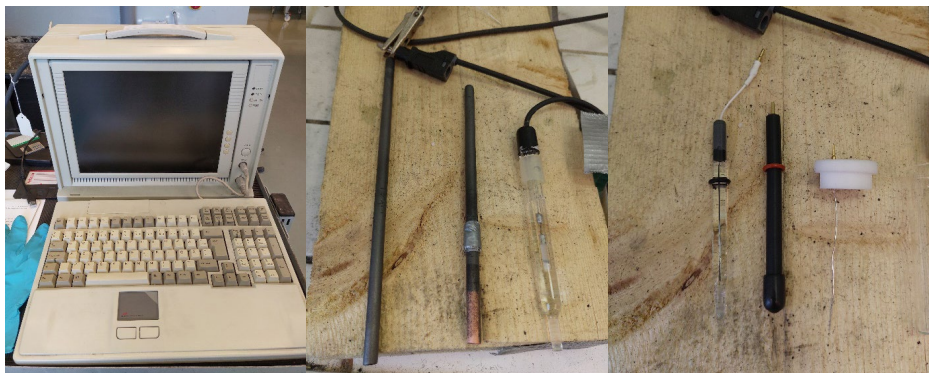
KUVA 3. Gamryn potentiostaatti (vas.) ja käytetyt elektrodit: hiilsauvat, SCE (kesk.), Ag/AgCl, Glassy carbon ja platinalanka (oik.). (kuvat Tatu Kauppi)
