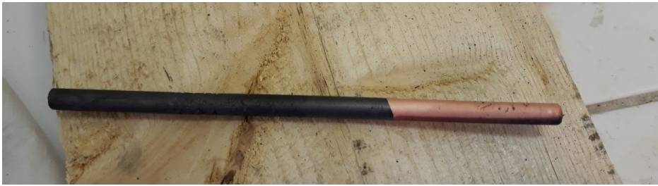
KUVA 5. Grafiittisauvalle pelkistynyt kupari. (kuva Tatu Kauppi)
