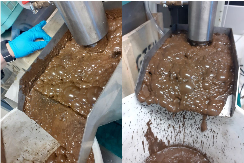
KUVA 4. Rypsiöljykokeissa ylitteeksi muodostuva vaahto. Vaahdotusaineena mäntyöljy 1 (vas.) ja 2 (oik.) (kuva Teija Härkönen)
