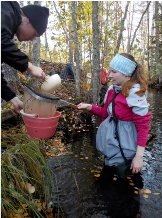
Kuva 32. Karelia-ammattikorkeakoulun energia- ja ympäristötekniikan opiskelijat Tommi Pöllänen ja Merva Nyholm siivilöivät potkuhaavilla otettua pohjaeläinnäytettä Kissapuron Ylätammen havaintopaikalla 01.10.2020.
