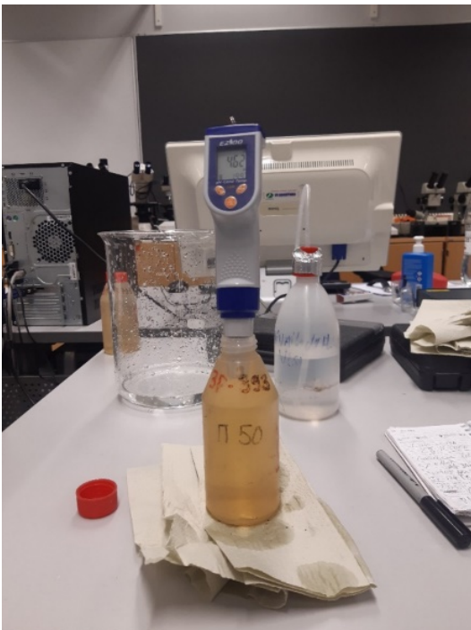
Kuva 27. Kissapuron vesinäytteiden pH-mittaus 09.12.2020.
