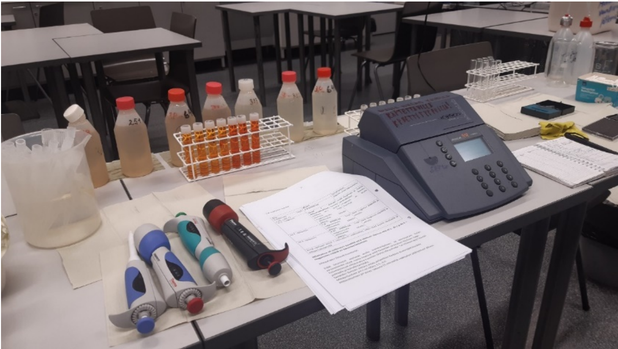
Kuva 26. Kissapuron vesinäytteiden metallipitoisuuksien mittaus WTW S 12 A –filterifotometrillä 09.12.2020.
