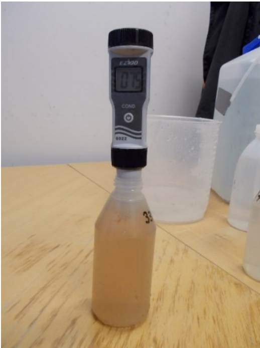
Kuva 28. Kissapuron vesinäytteiden sähkönjohtavuuden mittaus 09.12.2020.
