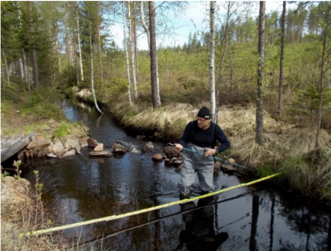
Kuva 16. Tarmo Tossavainen valmistautuu virtaamamittaukseen Kissapurin alajuoksulla 02.06.2020. Mittaajan selän takana on pohjakynnys, jonka ansiosta osa Kissapurin vedestä ja samalla ainevirtaamasta ohjautuu vasemmalla pilkottavaan mutkittelevaan eli meandroivaan uomaan. Kuva: Vesa Antikainen.
