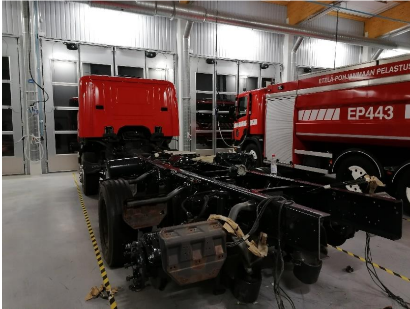
Kuva 4 Runko maalattuna ja kaapelointityö aloitettu.
