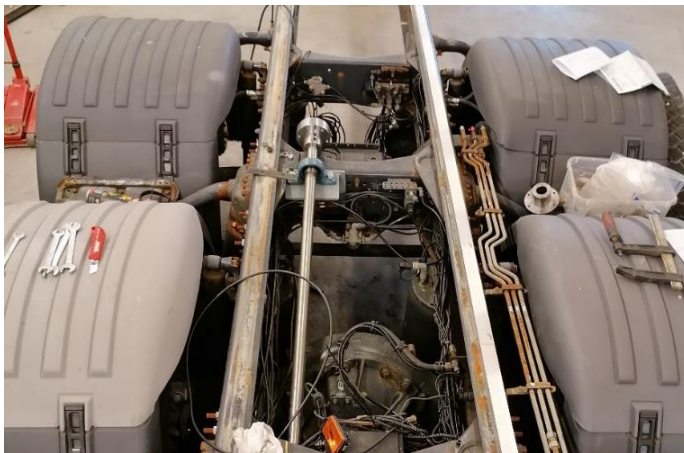
Kuva 3 Palopumpun akseliston asennus
