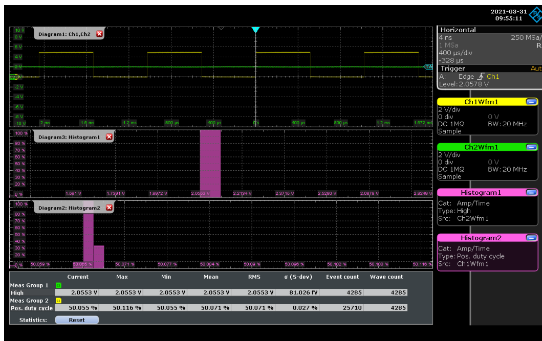
Kuva 20. PWM-signaali ja suodatettu referenssjännite reaalkytkenässä /21/.
