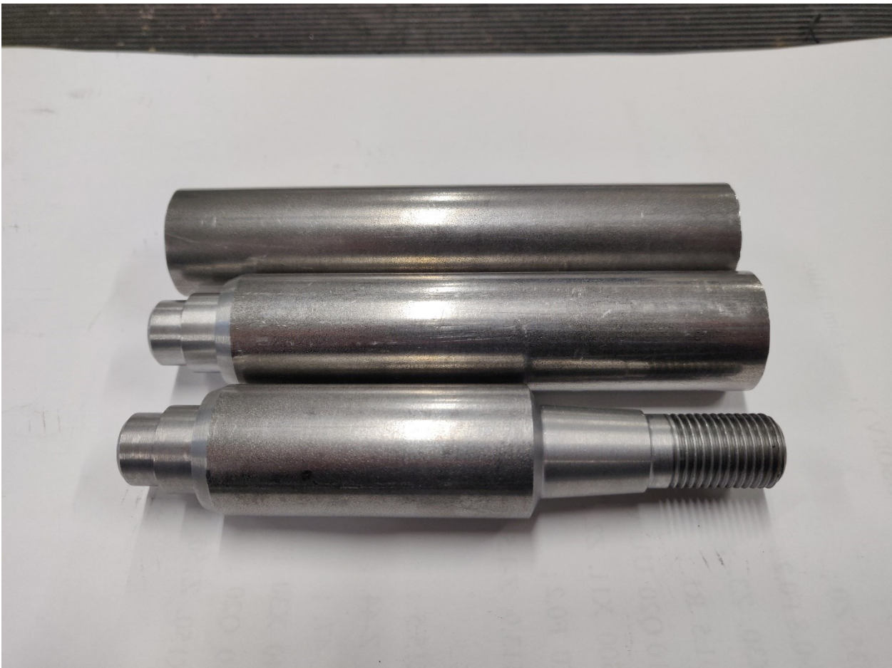
KUVA 33. Aihio ja valmis tuote.
