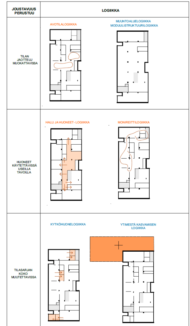
Kuvassa esimerkki joustavuuden logiikoiden jaottelusta koulurakennuksessa. Kuva 4
