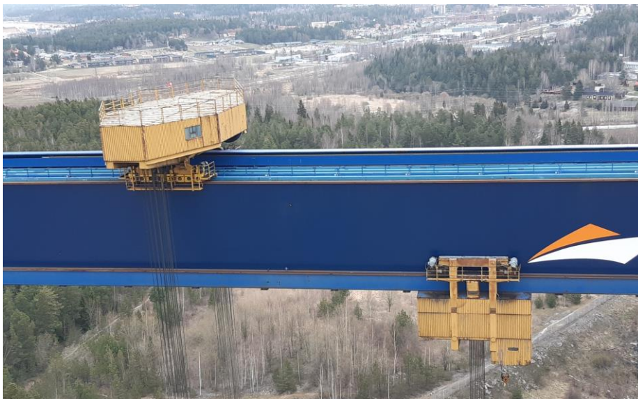
Kuva 4. K4800-Pukkinosturin ylä- ja alavaunu.
