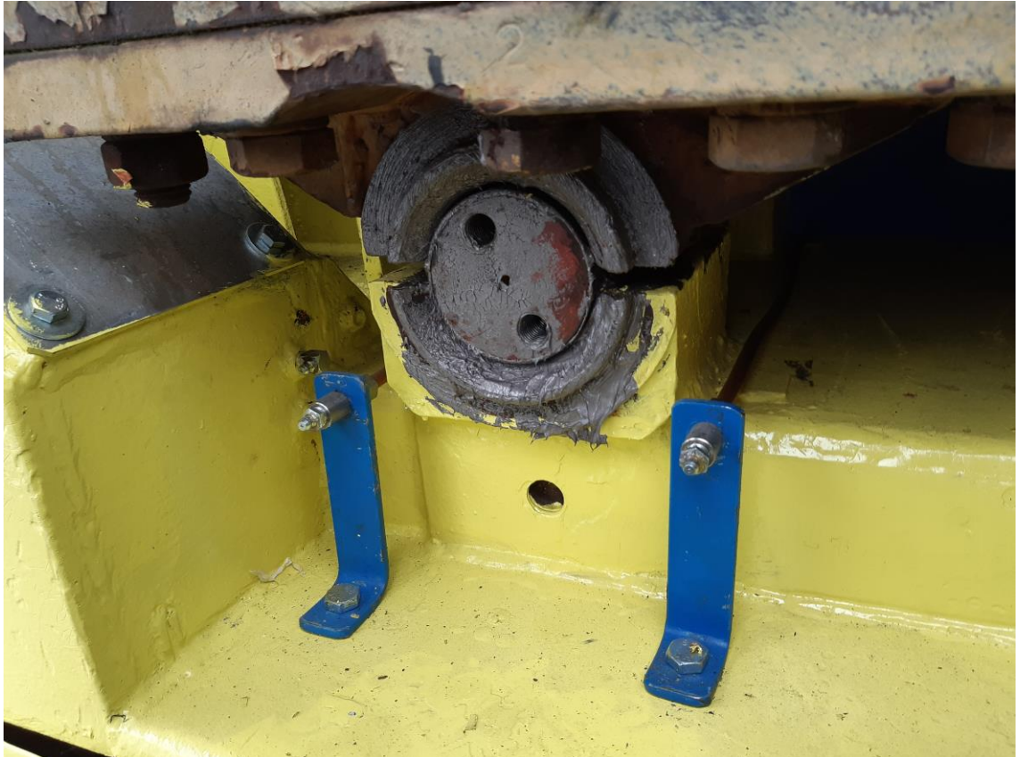
Kuva 10. Telin kiinnitys alavaunurakenteeseen.
