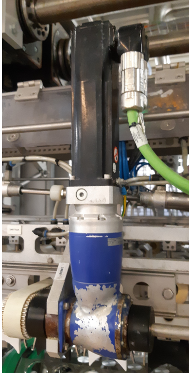
KUVA 4. Alustalle pakkaajan servomoottori (musta) ja vaihdelaatikko (sininen).
