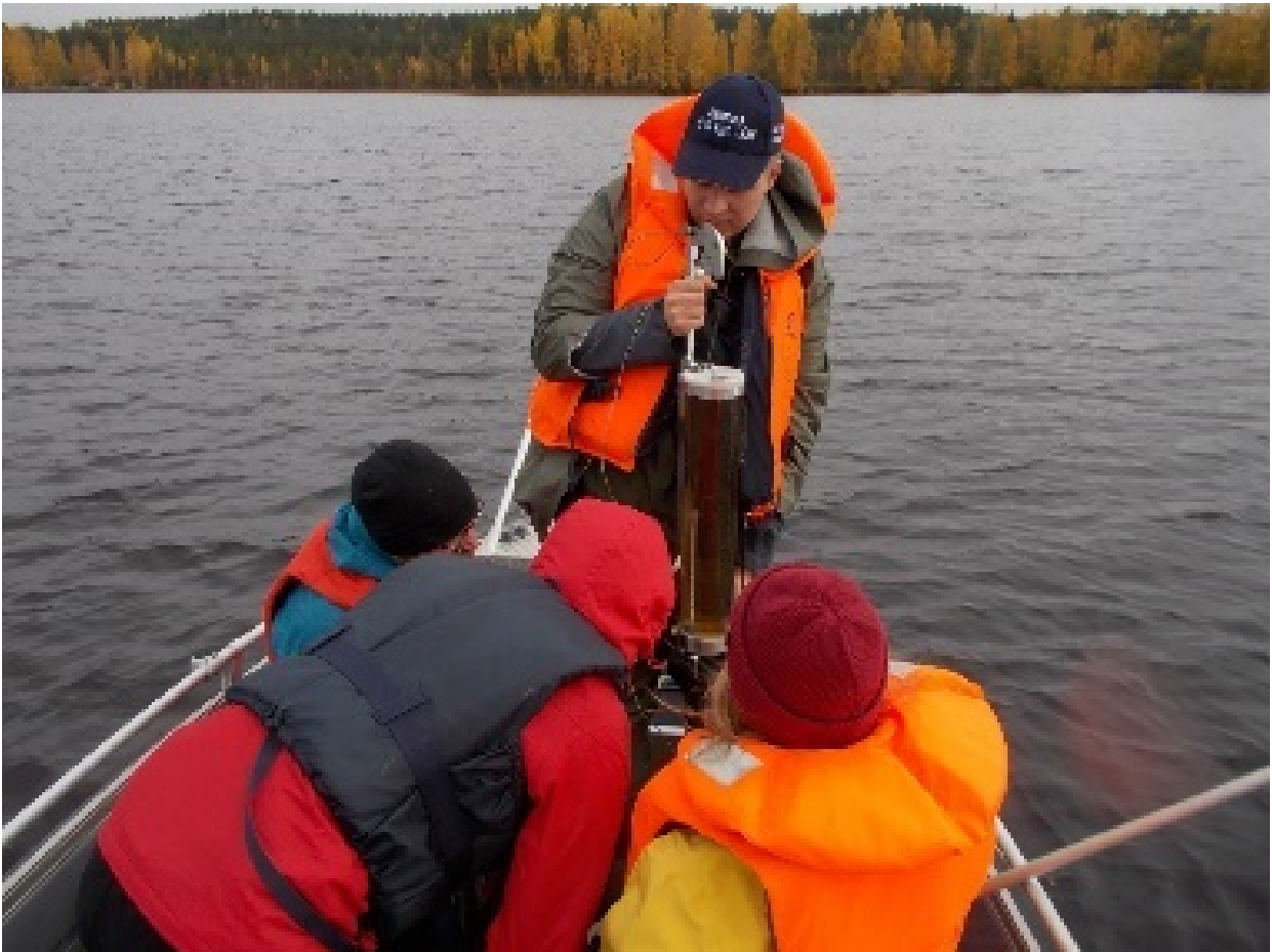
Kuva 16. Karelia-ammattikorkeakoulun energia- ja ympäristötekniikan opiskelijat ovat ottamassa vesinäytteitä laboratorioanalyysjä varten ja määrittämässä järviveden lämpötilaa Limnos-vesinäytteenottimen lämpömittarin avulla. Laitetta pitelee Lasse Rautiainen.
