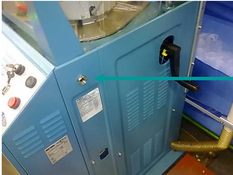
Kuva 24. Yläkannen oikean puoleinen sulkemispainike
