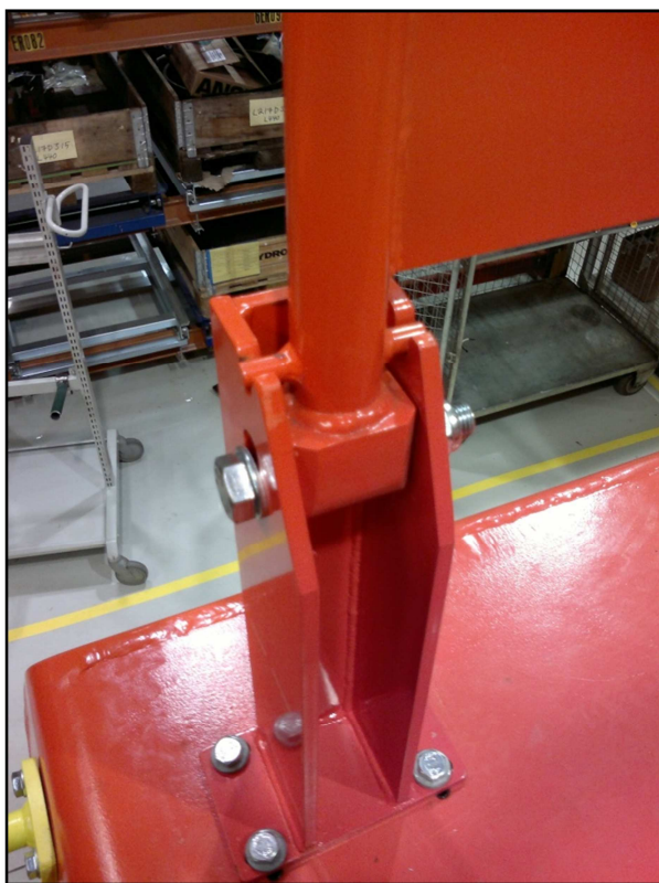
Kuva 4. Huoltokaiteen jalka, lukitusmekanismi ja nivelöinti.
