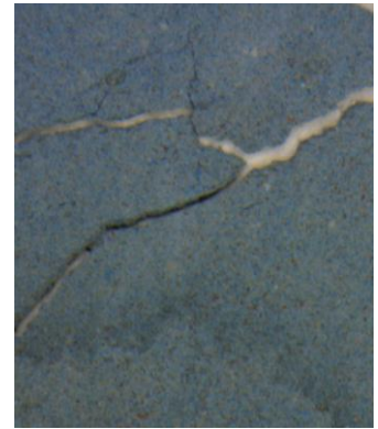
Kuva 9. Vuoden 1962 liimaväripintaa sektorilta 2. Dino-Lite-digitaalimikroskooppikuva.
