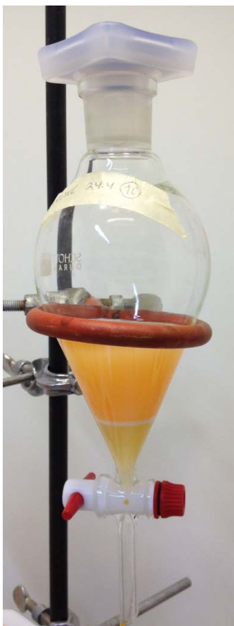
KUVA 24. Testin 3 biodiesel viimeisen pesun jälkeen
