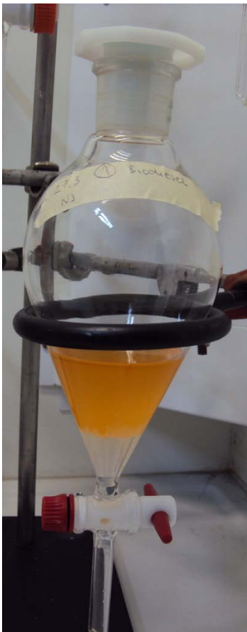
KUVA 17. Testin 1 biodiesel viimeisen pesun jälkeen
