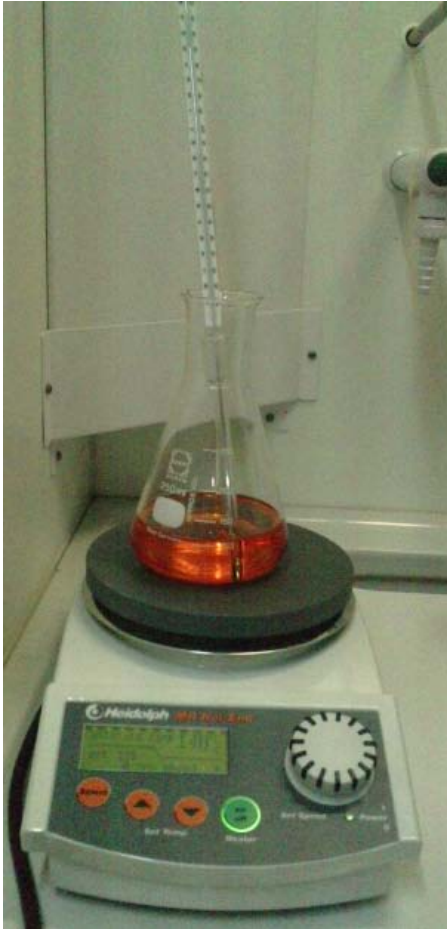
KUVA 4. Biodieselin valmistusprosessissa käytettävän öljyn lämmitys
