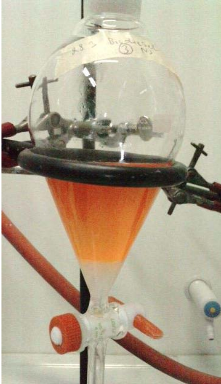
KUVA 10. Pesuveden ja biodieselin erottuminen (testi1)
