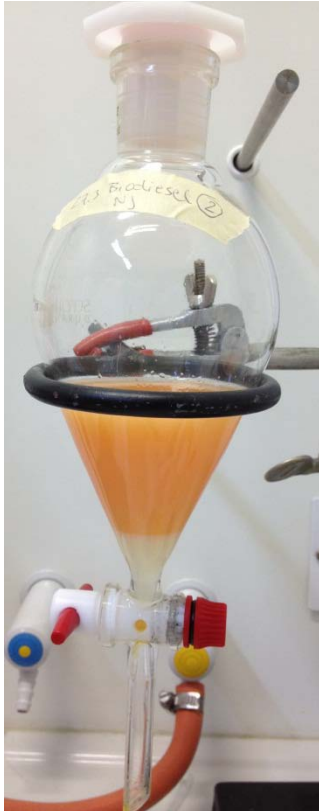
KUVA 20. Testin 2 biodiesel viimeisen pesun jälkeen
