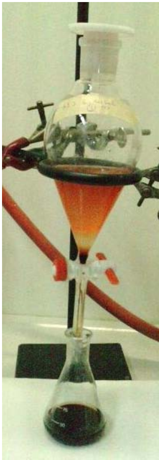
KUVA 9. Biodieselin valmistus metanolia käyttämällä (testi 1)
