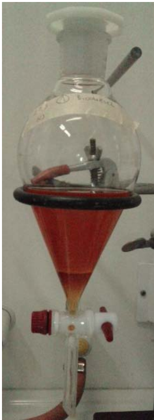
KUVA 16. Testin 1 biodiesel ensimmäisen pesun jälkeen
