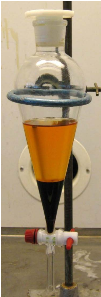
KUVA 5. Biodieselin ja glyserolin erottuminen (Kuva: Piia Soili 2012)
