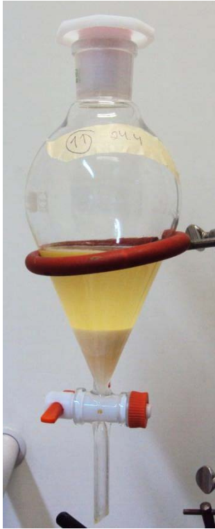
KUVA 28. Testin 4 biodiesel viimeisen pesun jälkeen
