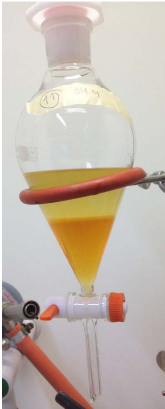
KUVA 27. Testin 4 biodiesel ensimmäisen pesun jälkeen
