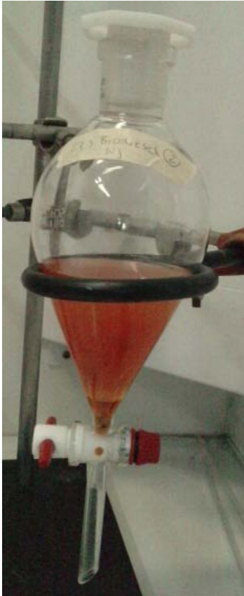
KUVA 19. Testin 2 biodiesel ensimmäisen pesun jälkeen
