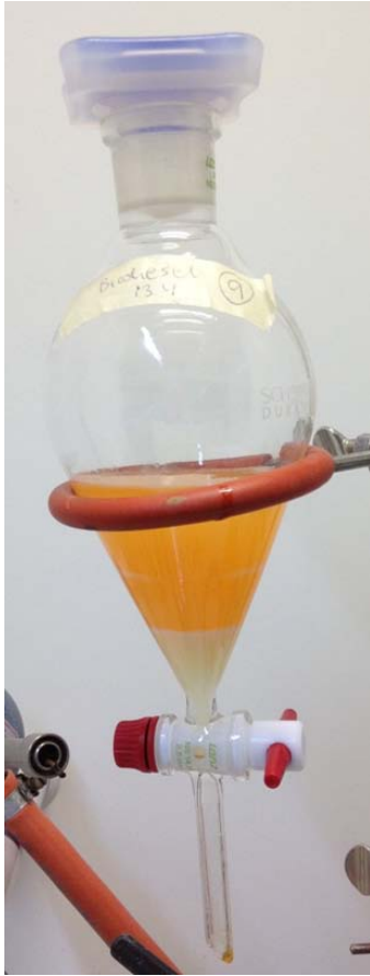
KUVA 6. Tilanne biodieselin valmistuksessa pesun jälkeen
