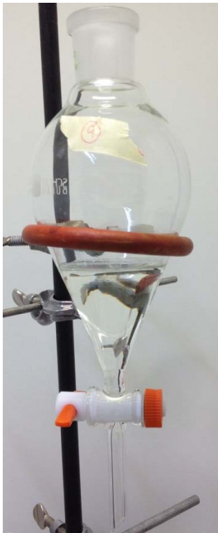
KUVA 14. Metanolitestin tulos testin 2 biodieselillä
