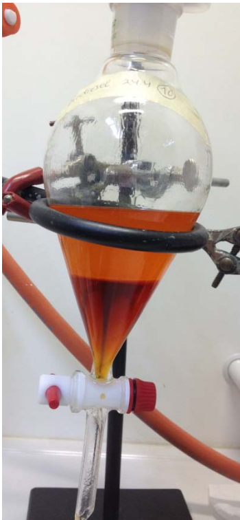
KUVA 23. Testin 3 biodiesel ensimmäisen pesun jälkeen
