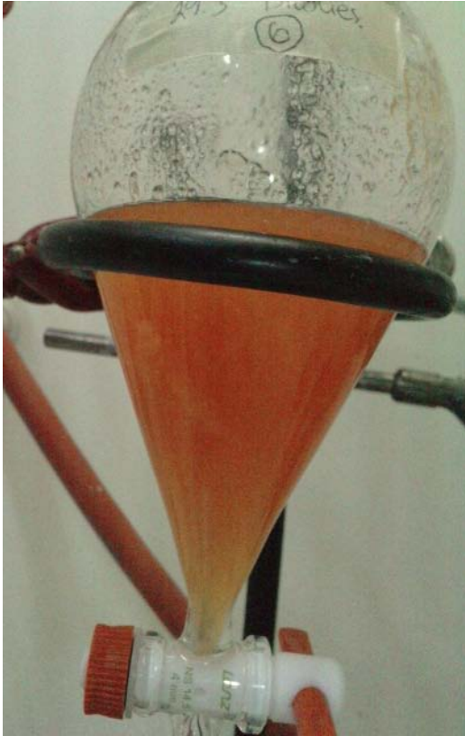
KUVA 31. Testin 1 paakkuuntunut näyte
