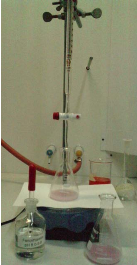
KUVA 2. Vapaiden rasvahappojen määrittämiseen käytettävä titrauslaitteisto
