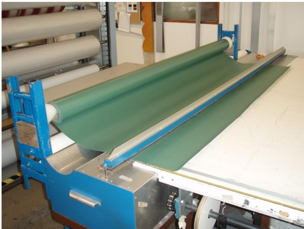
Figur 10. Tygrullsfastsättningen vid tygskäraren.
