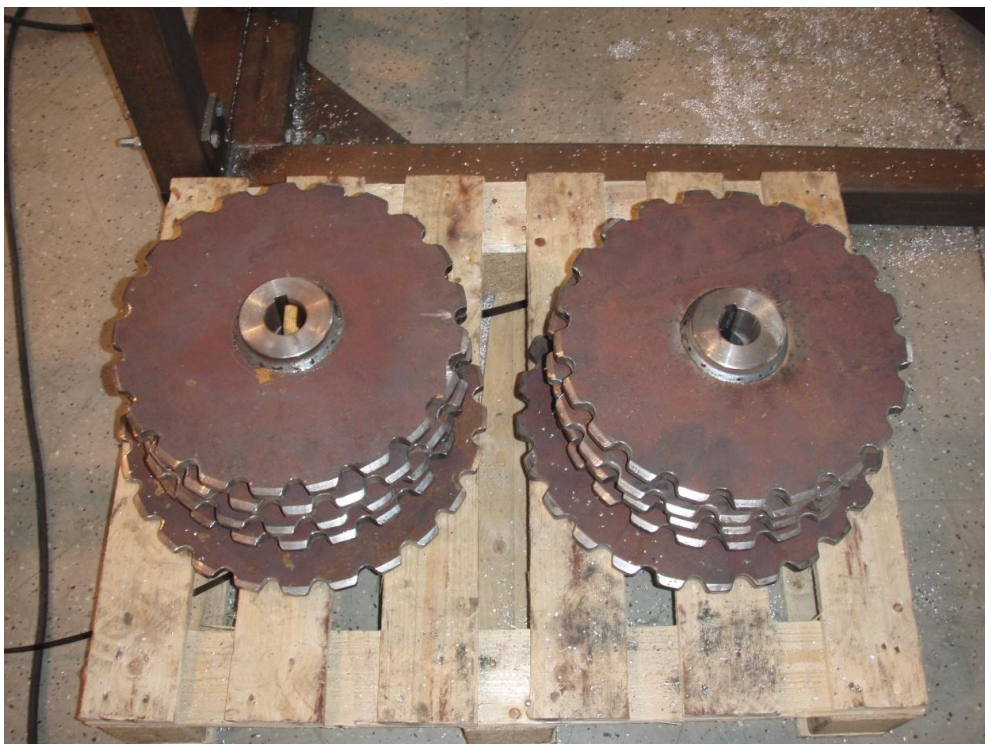
Figur 15. De färdiga utskurna kugghjulen till drivkedjan.
