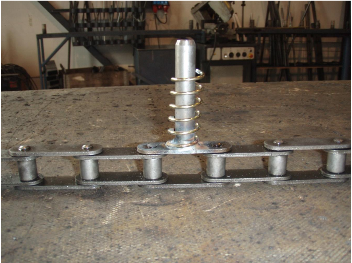
Bilaga3. Närbild på den fjäderbelastade infästningstappen
