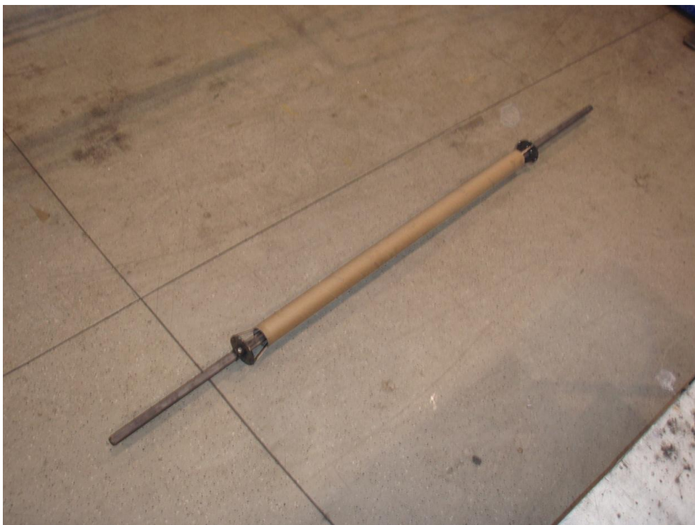
Figur 13. Tygröret festsatt med kondelen.
