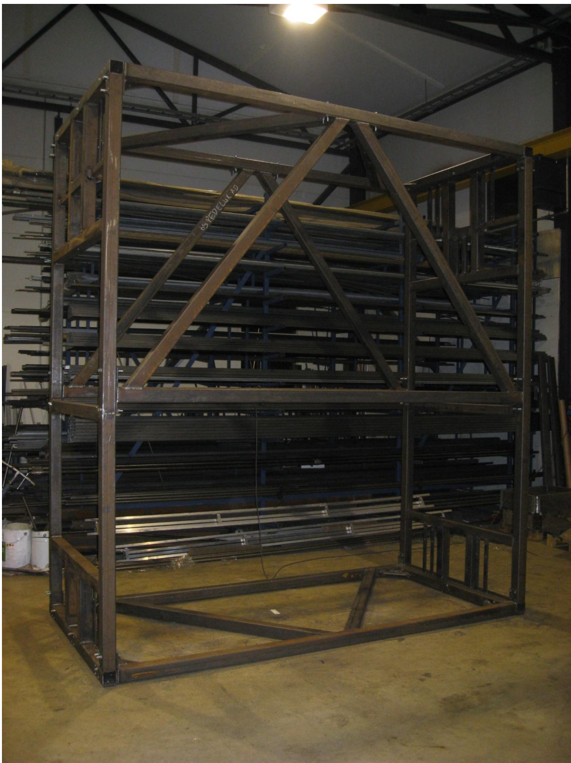
Bilaga 4. Bild över den färdigt svetsade stommen
