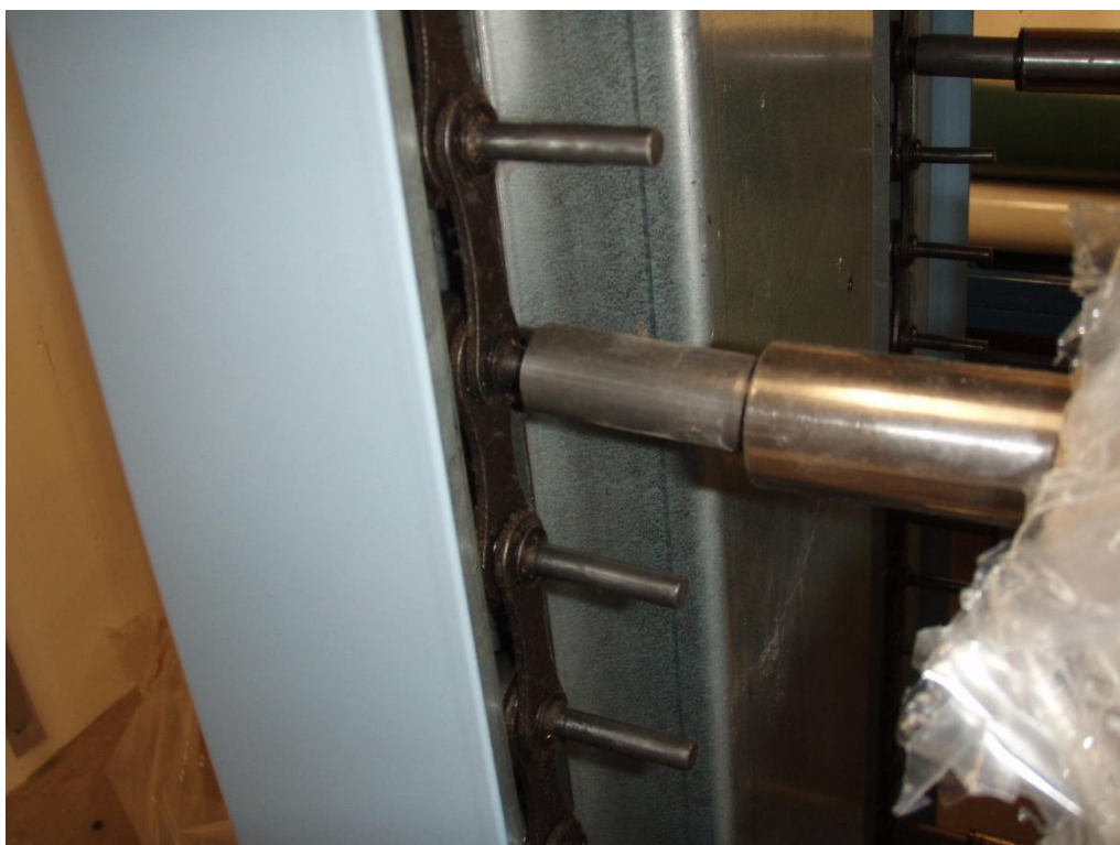
Figur 2. Bild på festsättningen hos det mindre paternosterverket.
