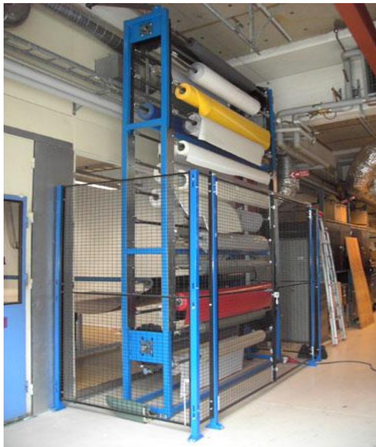
Figur 1. Relativ enkel paternosterkonstruktion. 5
