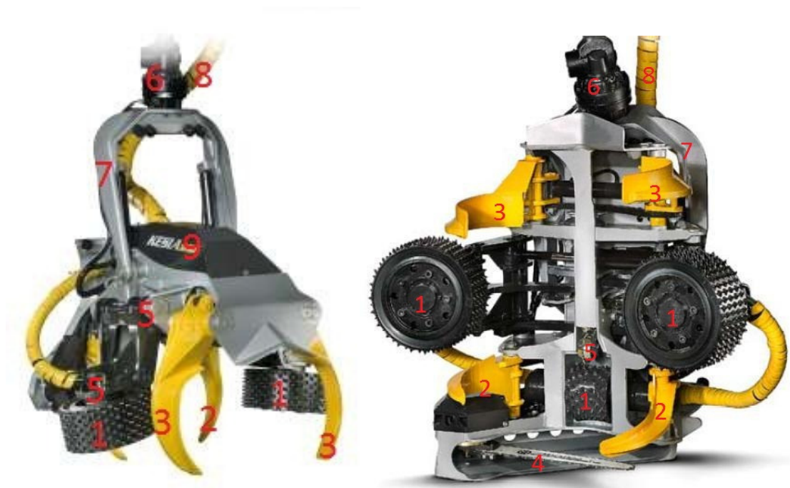
Kuva 3. Yksioteharvesterin rakenne; syöttörullat(1), takakarsintaveitset(2), etukarsintaveitset(3), saha(4), mittalaitteet(5), rotaattori(6), kallistussylinteri(7), puomikaapeli(8) ja venttiililohko(9). [11]
