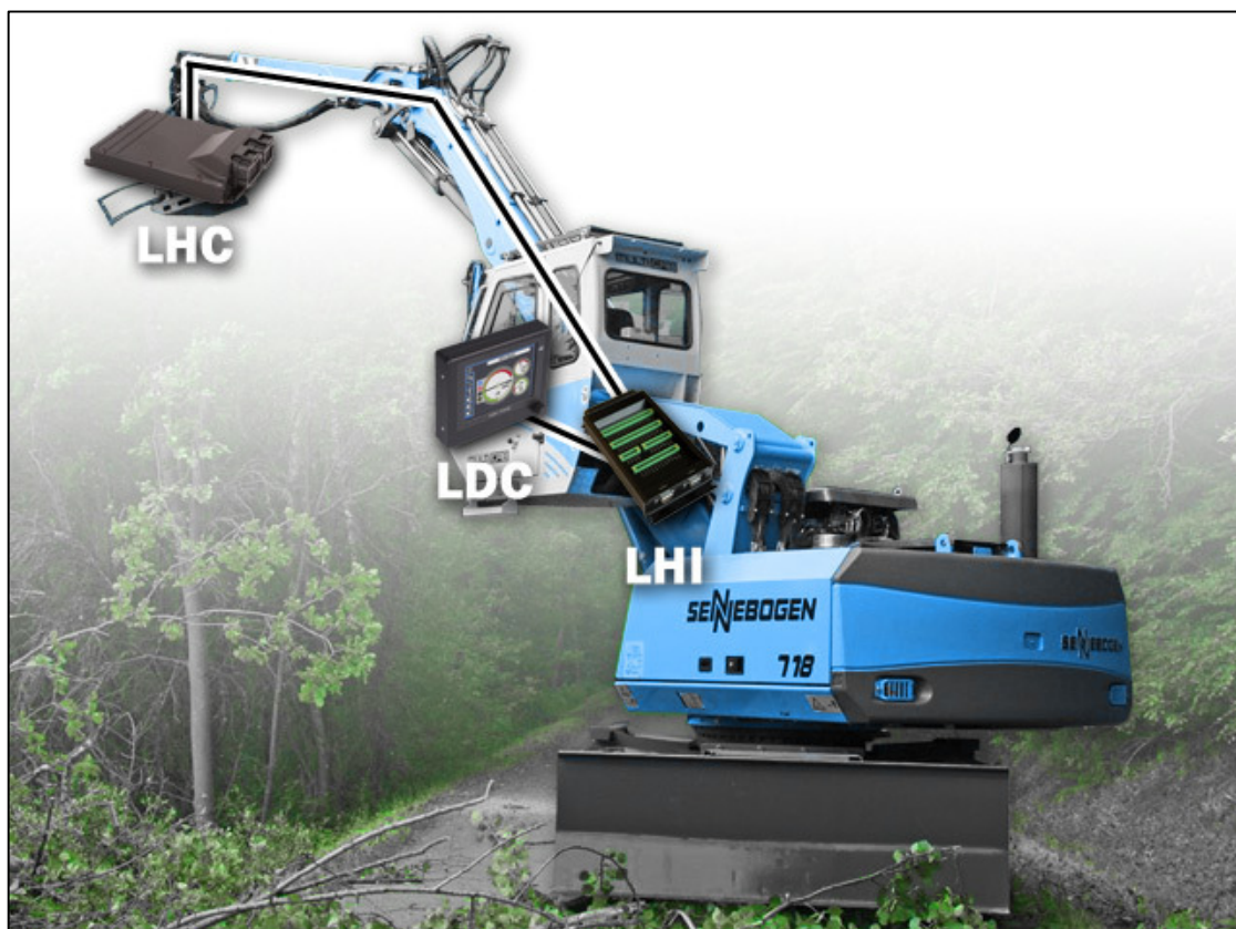
Kuva 5. Esimerkki metsäkoneen ohjaus- ja mittausjärjestelmästä. [15]
