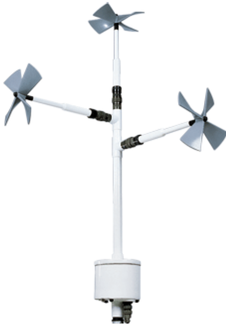
Kuva 4. Potkurianemometri kolmella propelilla (Alliance for Coastal Technologies).
