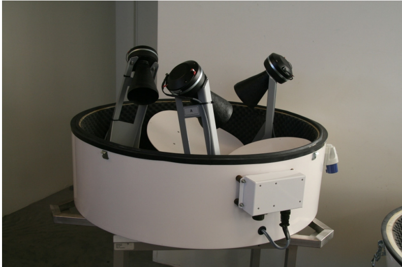
Kuva 15. SODARin ydin – äänitorvet ja peilit (Tuulisampo).
