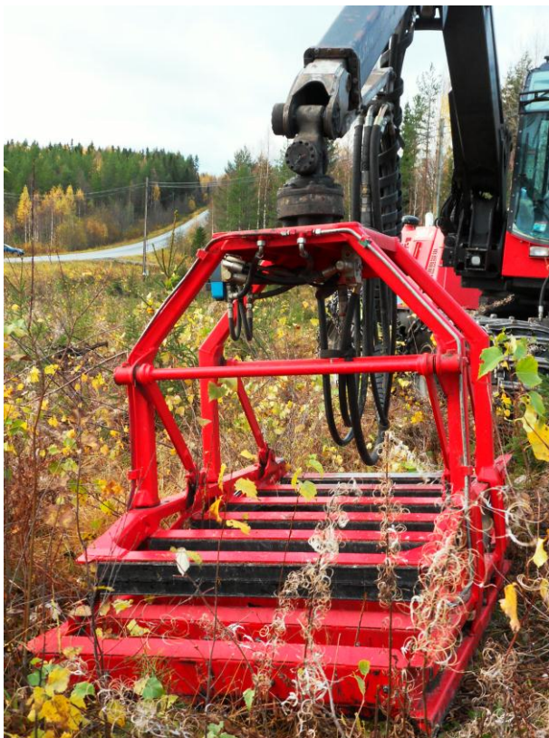
Kuva 2. Valmet (901.2) ja uudempi kitkevä Naarva-perkaaja.
