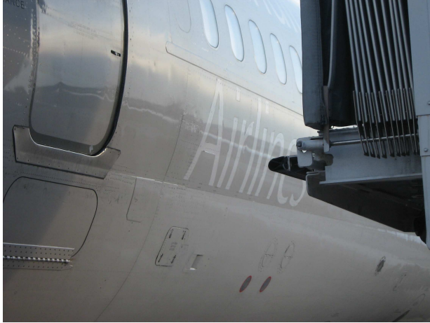
Kuva 22 Palje kiinnitettynä sektorilattiaan
