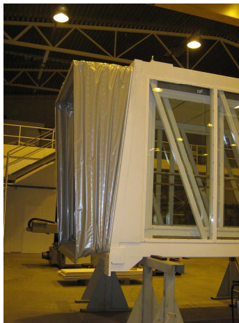
Kuva 17 Tunnelin ja terminaalin välinen välipalje
