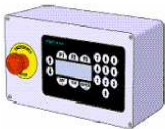
Kuva 40 VDGS- laitteen ohjauspaneeli
