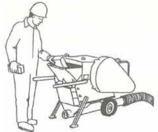
Kuva 18. Saneerausmurskain. Murskaimen avulla jäte on helppo imeä kohteesta ulos, aiheuttamatta pölyhaittaa muualle asuntoon. [15, s.8]
