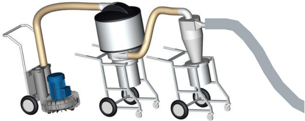
Kuva 3. Kokonainen imurijärjestelmä. Oikealta ensimmäisenä sykloniesierotin, toisena pussisuodatin ja viimeisenä imuturbiini ja moottori. [9]
